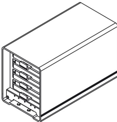
7. 本体内部の上面にあるツメに、前面パネル上部のツメを合わせるようにして、前面パネルを差し込みます。
