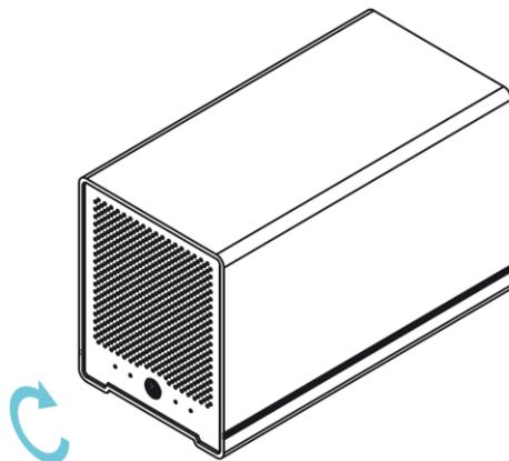
2. 前面パネルに手を添えながら、底面のロックスイッチを矢印の方向にスライドさせると、前面パネルのロックが外れて手前に倒れます。
