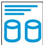
RAID 0 (ストライピング) は、パフォーマンス重視のタイプです。複数のハードディスク/SSD を論理的なひとつのディスクと見なします。
