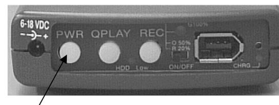
PWR ボタンを押すことによって、本機の電源がオンになります。本機が DV カメラやコンピュータからのデータに同期するまで、PWR ボタン(緑)と REC ボタン(赤)は同時に 1 秒間隔で点滅を始めます。このプロセス全体はおおよそ 10～15 秒間続きます。PWR ボタンが点滅をやめ、REC ボタンが消灯した時点で、録画やファイルアクセスができる準備ができています。
