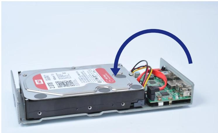
5. ハードディスクを落とさないよう支えながら、基板トレイを裏返し、4本のネジ(大)を使ってハードディスクを基板トレイに固定します。
