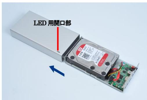
7. 底面のネジ(小)4本でケースと基板を固定します。最後に、ネジを取り付けた4か所へゴム足を取り付けて、作業完了です。
