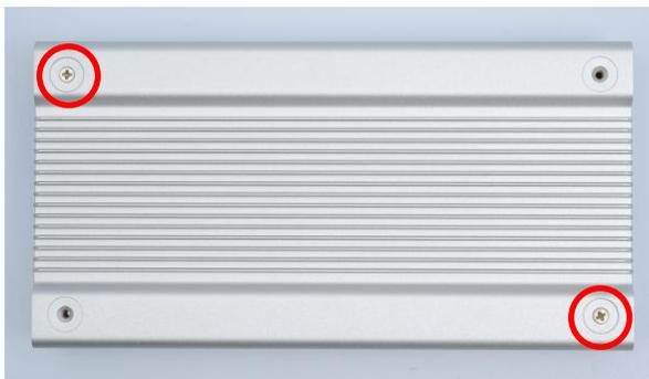
2. 写真のようにスライドさせて、基板トレイを取り出します。
