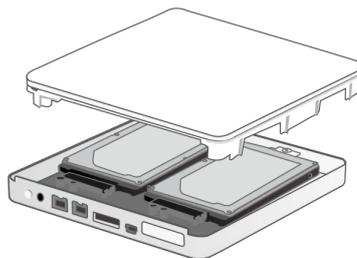
7. 上カバーを閉めたら、RebDrive RAID(kit)本体を両手で持ち、上カバーを押さえながら裏返し、四隅のネジをしっかりと締めます。以上で作業完了です。
