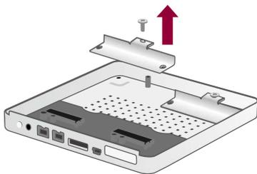
4. ハードディスクの、シリアル ATA コネクタ側と反対側にあるネジ穴にハードディスク設置ホルダーを固定し、ネジを締めます。
