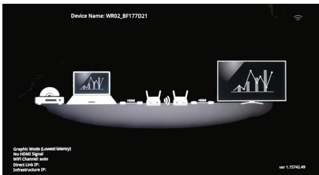
5. 送信機・受信機双方がWi-Fi 通信で接続に成功すると、[LINK]のLEDが点滅します。そのままお待ちいただければ、ディスプレイに映像送信元端末の映像・音声が出せられます。
