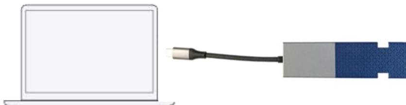
端末の USB Type-C ポートから送信機に給電ができるため、③ USB-C 変換コネクタ を使用する場合は、④ 電源供給専用ケーブル は使用しません。
