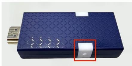
送信機のミラーリングボタンを3秒以上長押しすると、LEDが赤・青に高速点滅します。その後LEDが赤く点灯・点滅すれば、送信機のマルチキャストモードは解除され、通常のミラーリングモードになっています。
