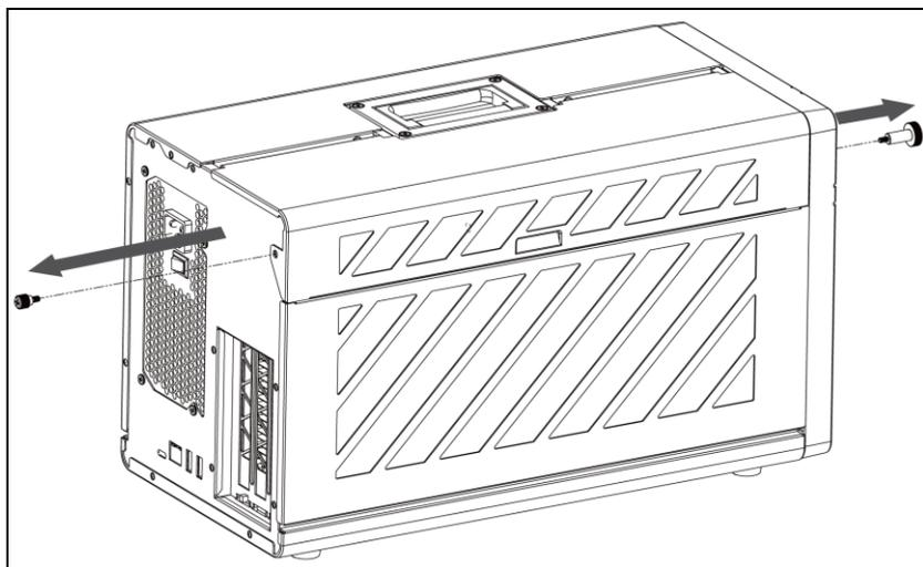
2. 上面パネルを上を開いてから、下面パネルを手前に倒して開きます。
