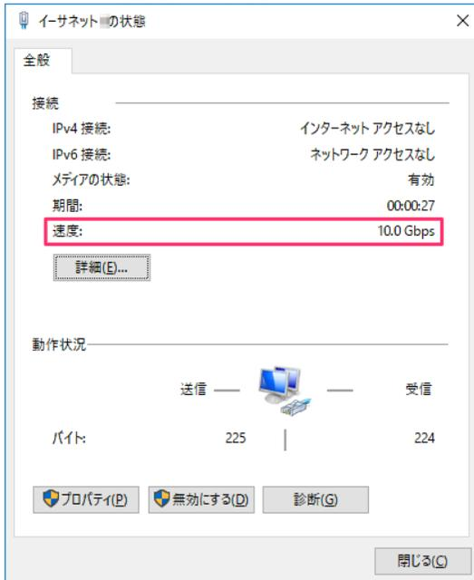
「TN9210 10GBase-T Ethernet Adapter」の IP アドレスを設定すれば、本体を使った 10GBASE-T 高速データ通信が利用できるようになります。
