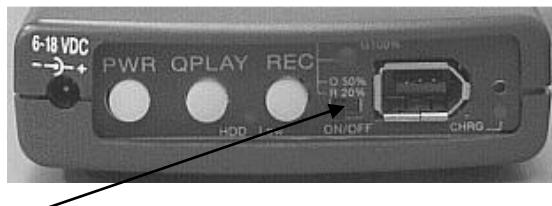
主電源スイッチはパネルの前部、REC ボタンのすぐ横に位置しています。白い点のある位置へスイッチをスライドさせた時、主電源スイッチがオンの状態となります。ご使用になる前には主電源スイッチをオンにしてください。保管中あるいは輸送中にはバッテリの消耗を避けるために主電源スイッチをオフにしてください。主電源スイッチがオフにセットしていても、バッテリ充電機能には影響を与えません。
