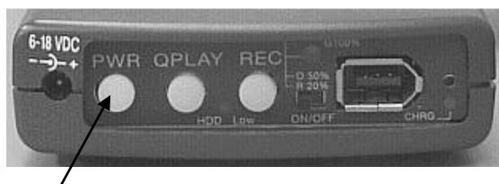
PWRボタンを押すことによって、本機の電源がオンになります。本機がDVカメラやコンピュータからのデータに同期するまで、PWRボタン(緑)とRECボタン(赤)は同時に1秒間隔で点滅を始めます。このプロセス全体はおよそ10~15秒間続きます。PWRボタンが点滅をやめ、RECボタンが消灯した時点で、録画やファイルアクセスができる準備ができます。
