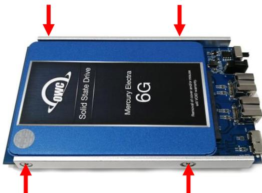
7. 金属パーツ(ヒートシンク)を本体ケースに収納します。金属パーツと本体ケース側双方のネジ穴を下に向けて、基板のコネクターがケースの外側になるように挿入してください。本体ケースの底面開口部から金属パーツのヒートシンク部分が露出する位置で固定します。
