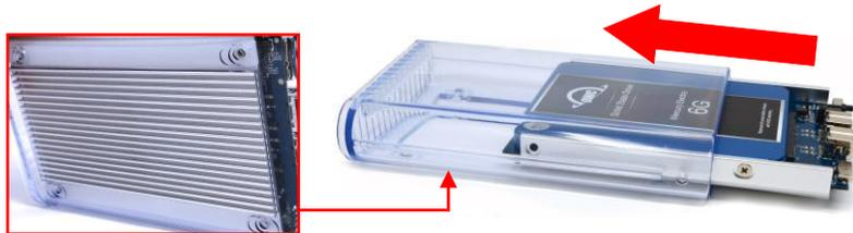
8. 下図の順番で4本のネジ(大)を使って、金属パーツ(ヒートシンク)を本体ケースに固定します。はじめに、本体ケースの底面を下に向けた状態で、ヒートシンクが開口部からずれないように注意しながら、下図の1本目のネジを3~4回まわして仮止めします。次に、1本目のネジの対角線側のネジを1本目と同様に仮止めします。仮止め後に、ヒートシンクが開口部からずれていないことを再度確認してから、2本のネジを完全に締めて固定してください。最後に、残り2本のネジを取り付けます。
