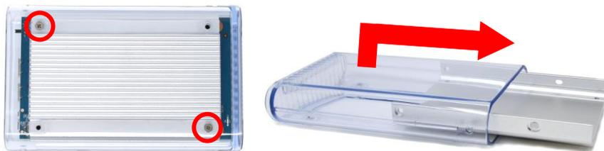
1. で取り出した基板にハードディスク/SSDを取り付けます。図のようにハードディスク/SSDをスライドさせて、SATAコネクタをしっかりと接続します。
