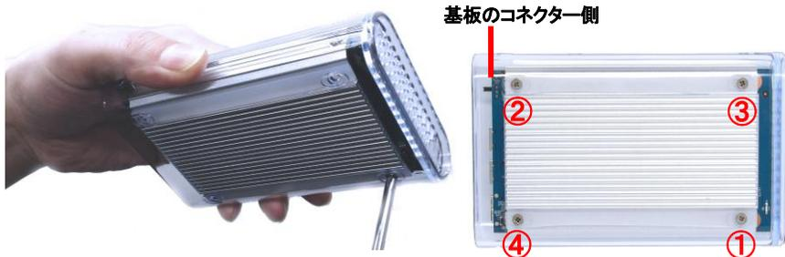
9. 基板側のコネクターと向きを合わせて、コネクターカバーを本体ケースに取り付けます。コネクターカバーを最奥まで押し込み、電源スイッチが操作できる状態であることを確認して下さい。
