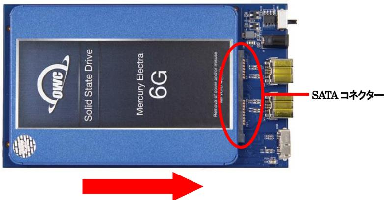
4. 基板を裏返し、4本のネジ(大)を使って、ハードディスク/SSDを基板トレイに固定します。
