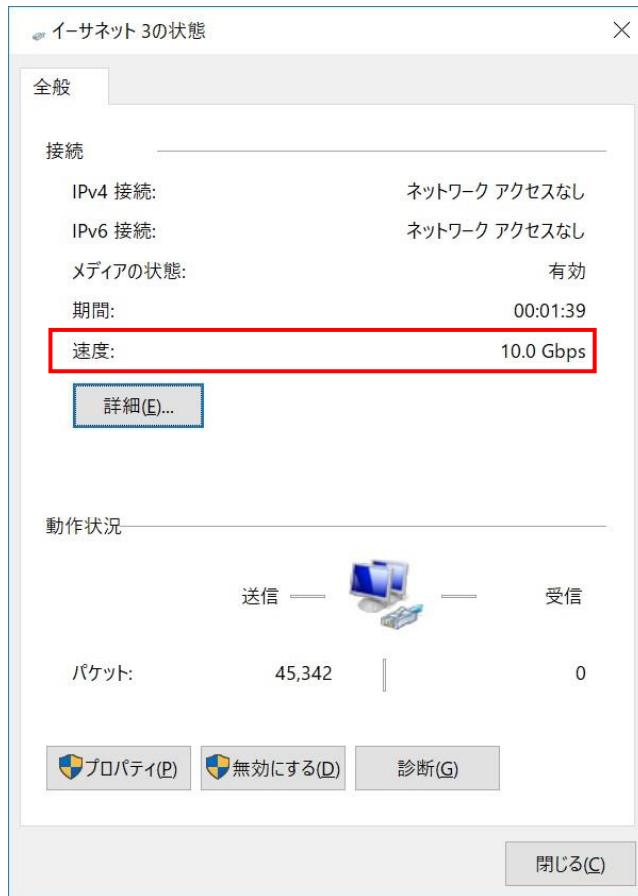
この状態で「T3-10G Adapter」の IP アドレスを設定すれば、本製品を使った 10GBASE-T 高速データ通信が利用できるようになります。
