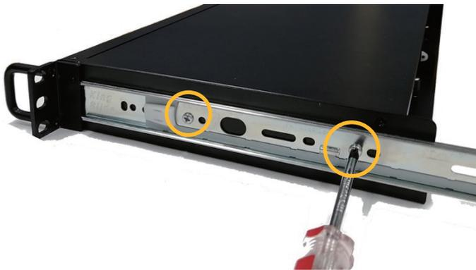
内側レールを左右それぞれ 2 か所ずつ、ネジ（小）でネジ止めして本製品の側面に取り付けます。
