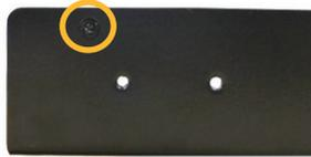
2. すべてのネジを外した後、上面パネルを後方にスライドさせてから持ち上げて外します。
